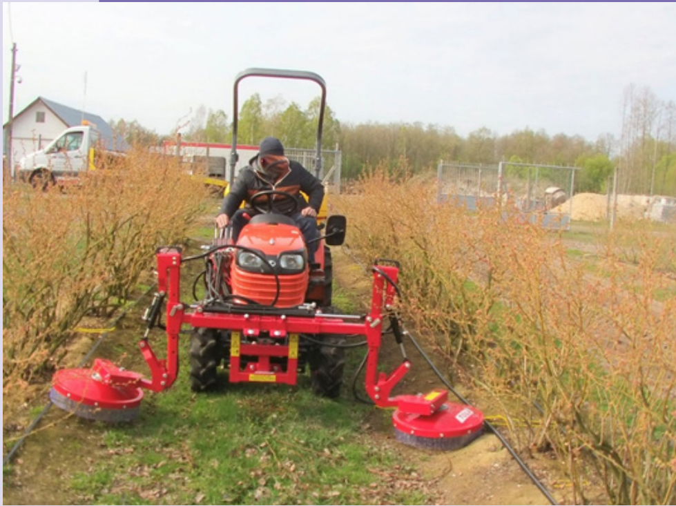
17 pav. Herbicidų purškimas šilauogyne, naudojant specializuotą techniką https://jagoda.com.pl/herbicide-spray-booms/herbicyde-beam-for-blueberry-tola/
